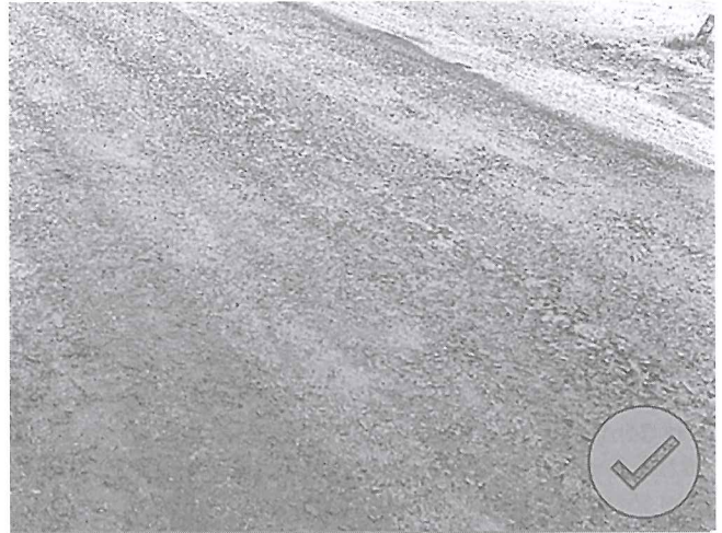
Bề mặt nhũ tương EcoPrime khô sau khi tưới 8 tiếng trong điều kiện ban đêm, nhiệt độ môi trường 23°C
