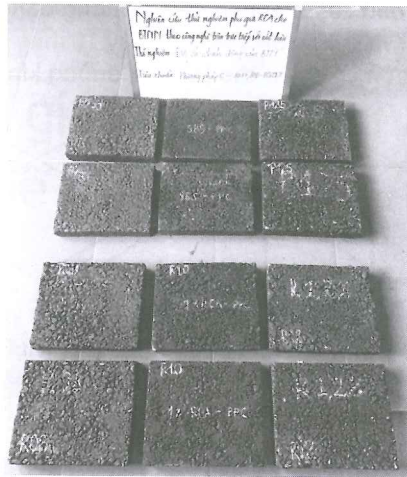
Hình 2.3: Các mẫu BTN sau khi thực hiện thí nghiệm xác định độ ổn định động
