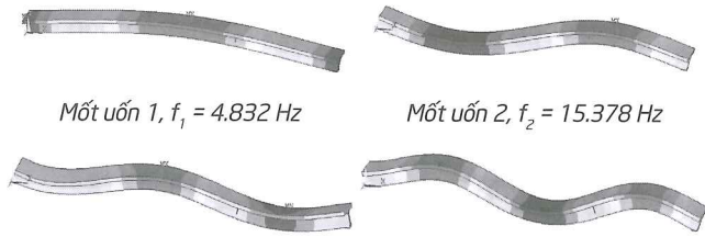
Hình 3.3: Bốn mốt uốn thẳng đứng của dầm nguyên
